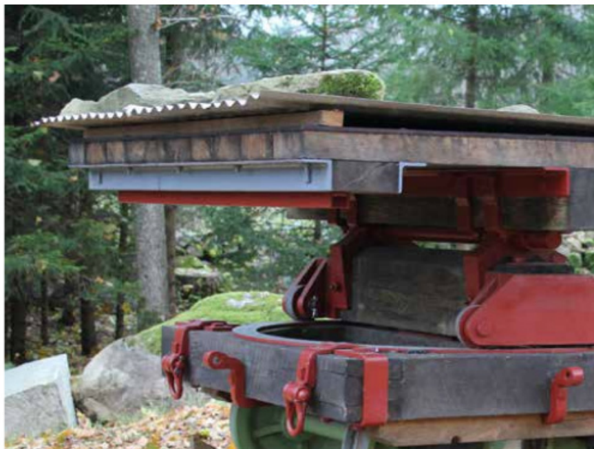
Tippvagn för skrotsten. Flaket vilar på fyra stålhjul vilka möjliggör att det är vridbart i 360 grader. Tippning kan då ske framåt eller åt någon av sidorna.
