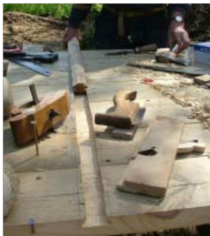
Dörplankorna är av gran och gradlisterna av ek. Gradspåret utmejslas med tre verktyg, från vänster grundklot, gradsåg och gradhyvel, varefter listen drivs in och förankras med en trätapp.
