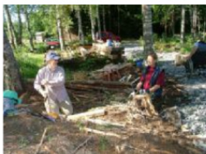
Här tillverkas trätappar s.k. dymlingar av torra grangrenar. Desirée Nilsson och AnneMo Gustafsson i arbete.
