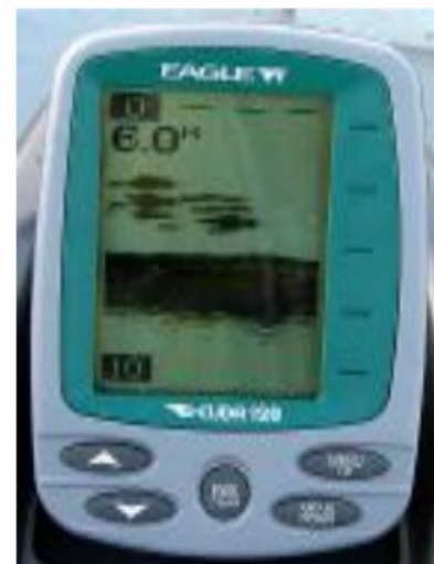
Bärbart ekolod, drivs med 8 AA-batterier, sonden fäst med sugpropp på aktern. Ett bra hjälpmedel för att lära känna sina fiskevatten.
